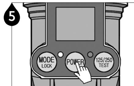
5 Drücken Sie die POWER-Taste für 2 Sekunden, um das Gerät einzuschalten.
