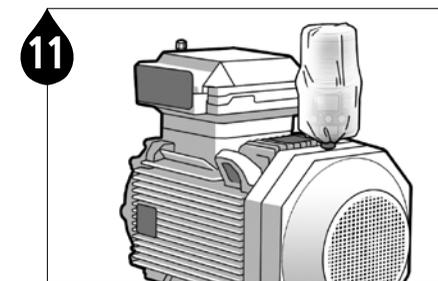
11 Setzen Sie den Staubabdeckung über dem Schmierstoffgeber, für einen zusätzlichen Schutz, auf.
