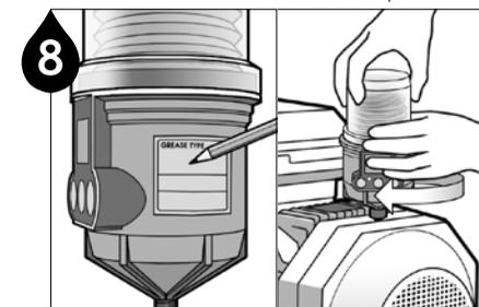
8 Befestigen Sie das beiliegendes Etikett am Schmierstoffgeber und notieren Sie das Installationsdatum. Installieren Sie den Schmierstoffgeber auf den zu schmierenden Punkt.
