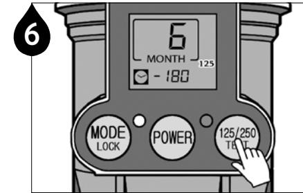
6 Wählen Sie den entsprechenden Fettbeutelkapazität durch das Drücken der 125/250-TEST-Taste. (Dieser Vorgang gilt nicht für 60ml und 500ml)
