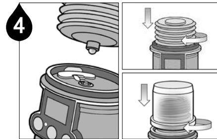
4 Drücken Sie den Fettbeutel, bis das Fett aus der Öffnung herauskommt und installieren Sie es anschließend. Nicht zu fest andrehen.
