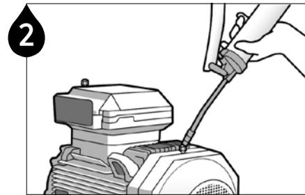
2 Stellen Sie einen freien Durchgang mit einer manuellen Fettpresse sicher. **Hinweis 1** Entfernen Sie jegliches gehärtetes Fett, indem Sie die Schmierstelle mit einer manuellen Fettpresse durchspülen. **Hinweis 2** Das Fett in der Ausrüstung und das enthaltene Fett in der Einheit sollten gleich oder kompatibel sein.
