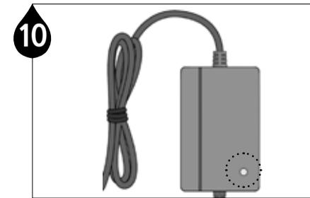
10 Stellen Sie sicher, dass die rote LED des VAC-Adapters (VDC-Wandlers) nach dem Einschalten blinkt.
