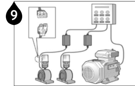
9 Schließen Sie den VAC-Adapter (VDCWandler) an das Bedienfeld an.
