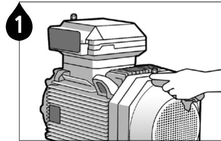
1 Entfernen Sie Verunreinigungen um die Schmierstelle.
