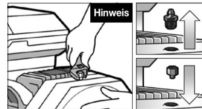
Entfernen Sie den Schmiernippel und installieren Sie die passenden Anschlüsse.
