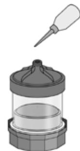
Füllen Sie Öl in die leere Einheit mit geeigneten Füllwerkzeug ein.
